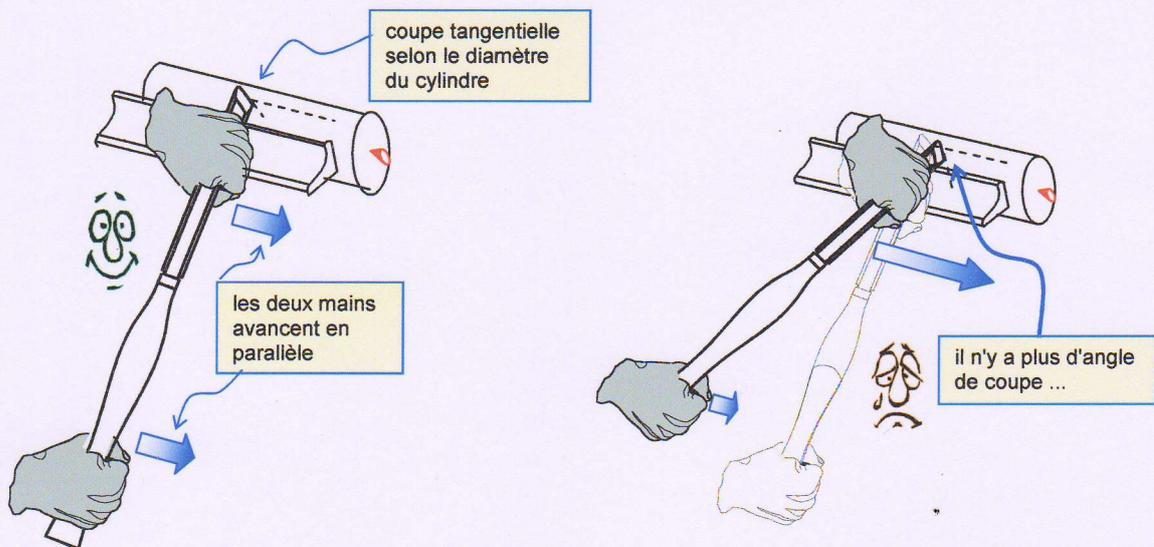
Le porte-outil doit être positionné suffisamment haut pour permettre une tenue de la plane **légèrement** inclinée vers le bas. En effet, une tenue d'outil trop inclinée vers le bas déplacerait inévitablement le point de coupe sur le haut du taillant, au fur et à mesure de son déplacement : accrochage assuré ... Je vous rappelle que le bois exerce une pression verticale tendant à rejeter l'outil vers le bas !
